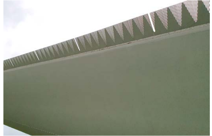
Figuur 4. Geluidreducerende vertanding (zaagtanden of 'serrations') aan de 'trailing edge' of achterzijde van een windturbineblad
